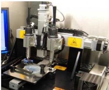
Fig. 16. Navogen MMX 3D bioprinter
